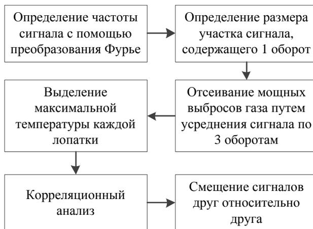
Рис. 3. Алгоритм обработки сигнала
