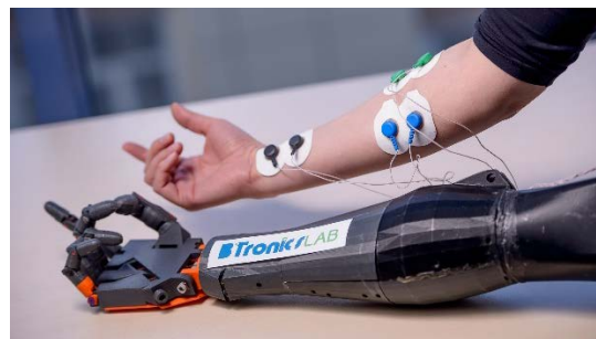
Рис. 3. Использование датчиков электромиографии для управления бионическим антропоморфным протезом
