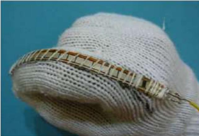
**Рис. 4. Положение датчика на хлопчатобумажной перчатке**
