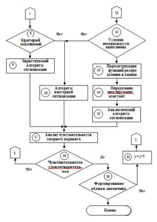
Рис. 2. Общая схема многоэтапной процедуры формирования облика БРЭС (продолжение)
